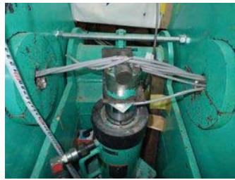
写真3 アンカーAの破断状況
