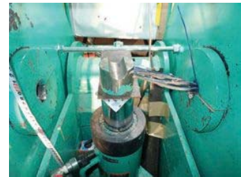
写真4 アンカーBの破断状況
