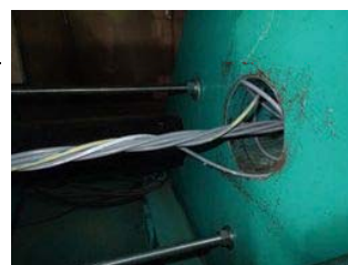
写真5 アンカーAの飛び出し状況 写真6 アンカーBの飛翔状況 写真7 アンカーAの解けの状況
