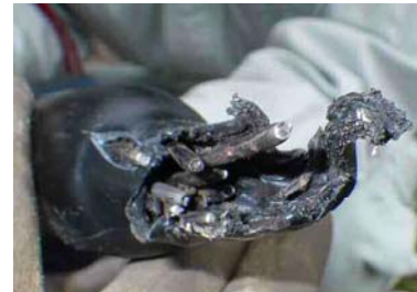
写真6. アンカー破断面
