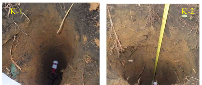
写真-2 K-1 と K-2 のテストピット (深さ 1m)
